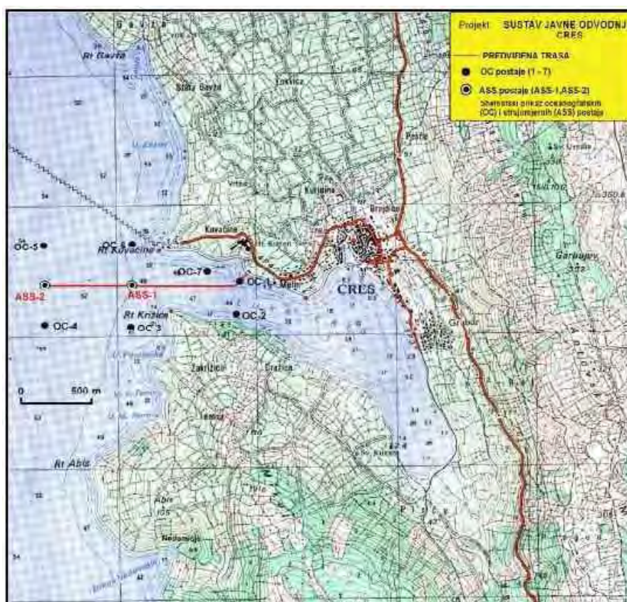
Slika 4.2.-1. Položaj oceanografskih (OC) i strujomjernih (ASS) postaja u akvatoriju oko podmorskog ispusta (HHI, 2006)
